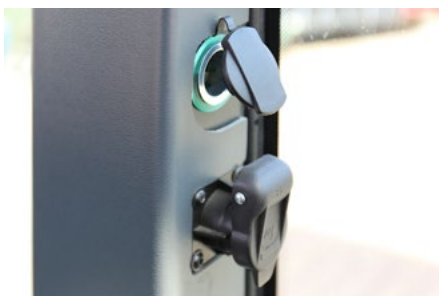
12 V stopcontact voor het laden van mobiele toestellen / stopcontact voor 3-polige toestellen
