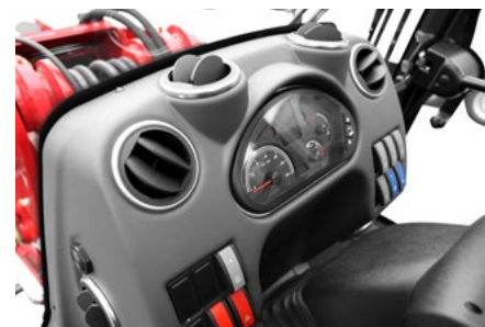
Bijkomstige, grotere ventilatieopeningen voor optimale luchtcirculatie / geoptimaliseerde schakelaars.
