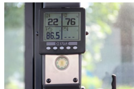
Nieuw informatiedisplay in de B-stijl voor het uitlaatsysteem (voor laders van de 86- en 96-serie)
