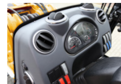
Bijkomstige, grotere ventilatieopeningen voor optimale luchtcirculatie / geoptimaliseerde schakelaars.
