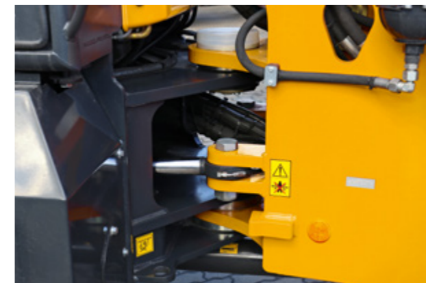
Het extreem grote scharniergewricht is onverwoestbaar en onderhoudsvrij. Hoge stuurhoeken zorgen voor wendbaarheid.
